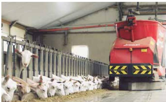
I robot di alimentazione hanno due coclee di miscelazione verticali con una capacità di 2,5 o 3 m<sup>3</sup> e sono adatti da 50 a 700 capi di bestiame.
