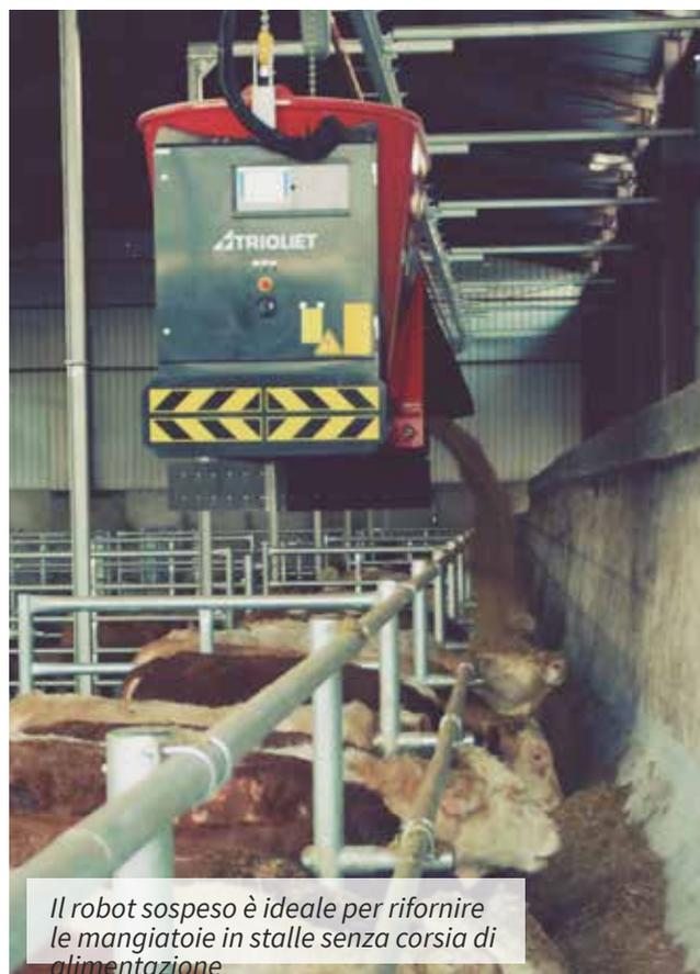
*Il robot sospeso è ideale per rifornire le mangiatoie in stalle senza corsia di alimentazione*
