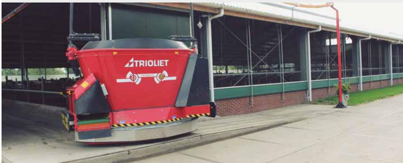
*Un robot di alimentazione è in grado di alimentare da 50 a 700 capi di bestiame ed è possibile utilizzare più robot in un unico sistema.*
