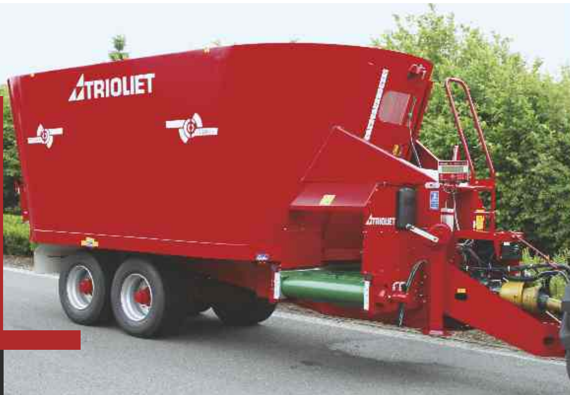
Typ VLX-BT je na přání možné vybavit příčným řetězovým dopravníkem vpředu.
