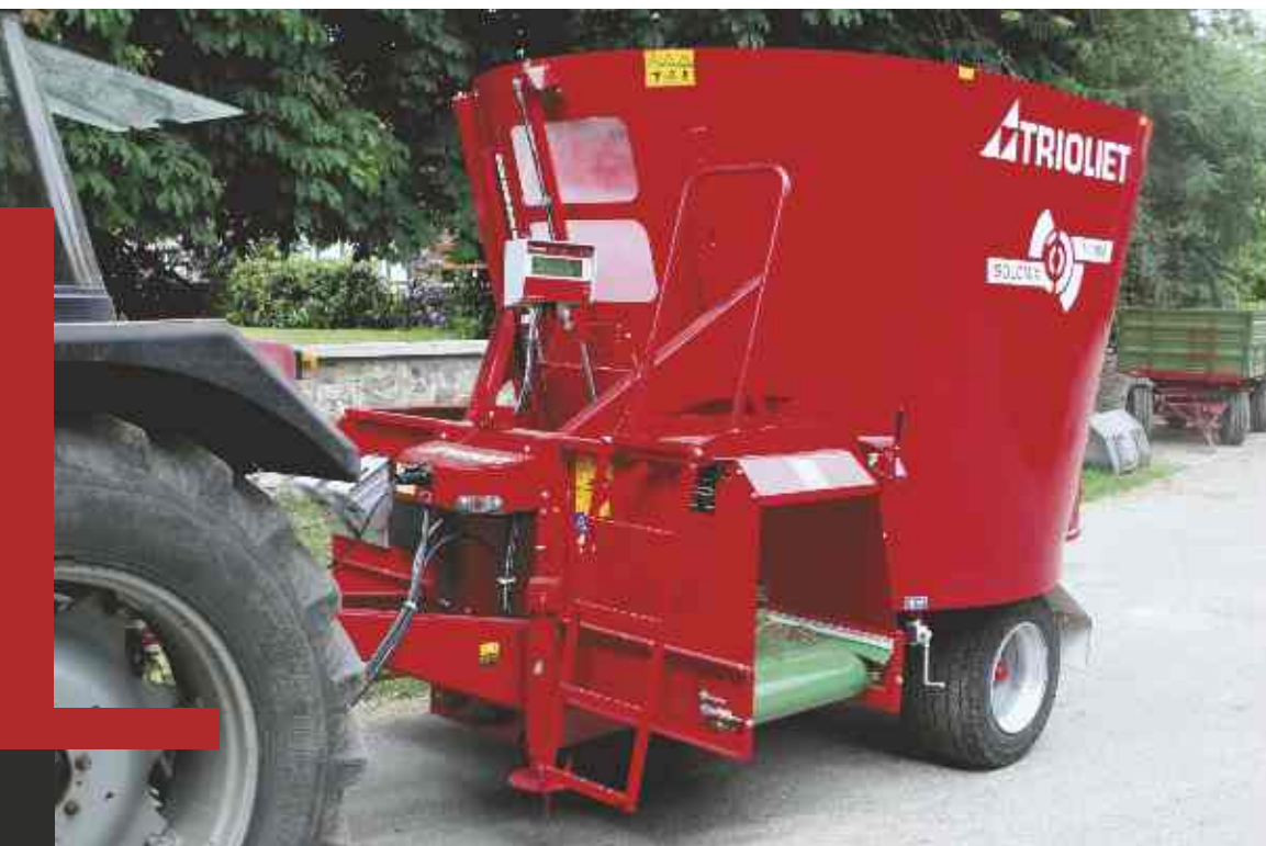
Solomix 1, Typ 1200 ALH-B s příčným dopravníkem vzadu.
