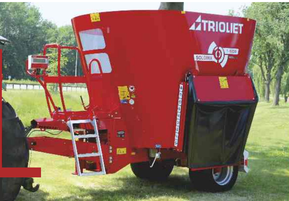
kompletní vyprázdnění vozu díky novému otvoru v provedení ZK.
